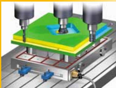
Otočení, hrubování, uvolnění (DEMAG/MAG) a obrábění na čisto 2. plochy
