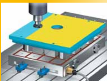
Otočení a obrábění na čisto 1. plochy
