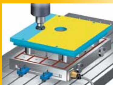
Otočení a obrábění na čisto 1. plochy
