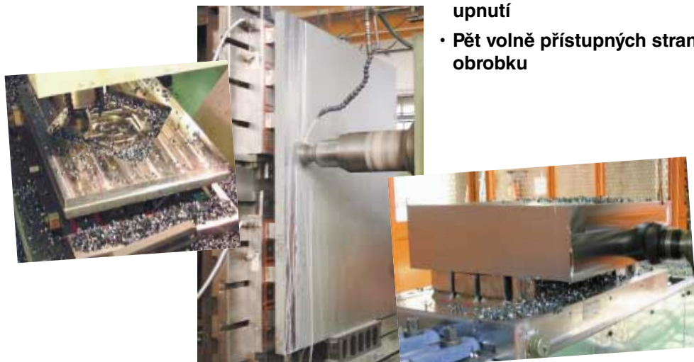
Otočení, hrubování, uvolnění (DEMAG/MAG) a obrábění na čisto 2. plochy
